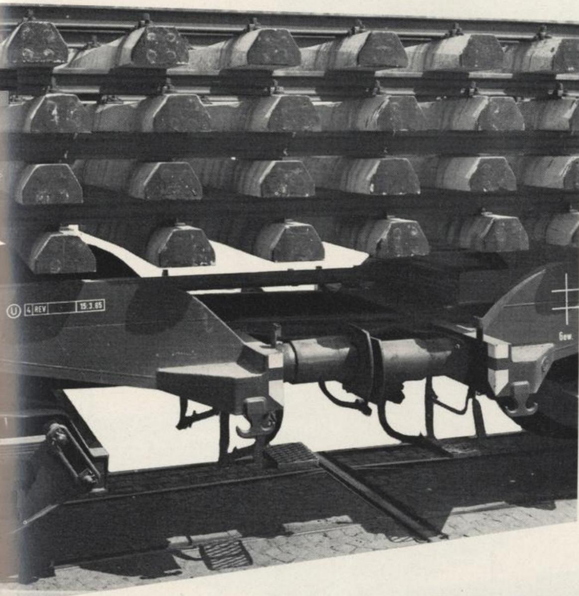
Überfahren der Hubwagen mit Last über die Übergangsschienen an den Kopfstücken
