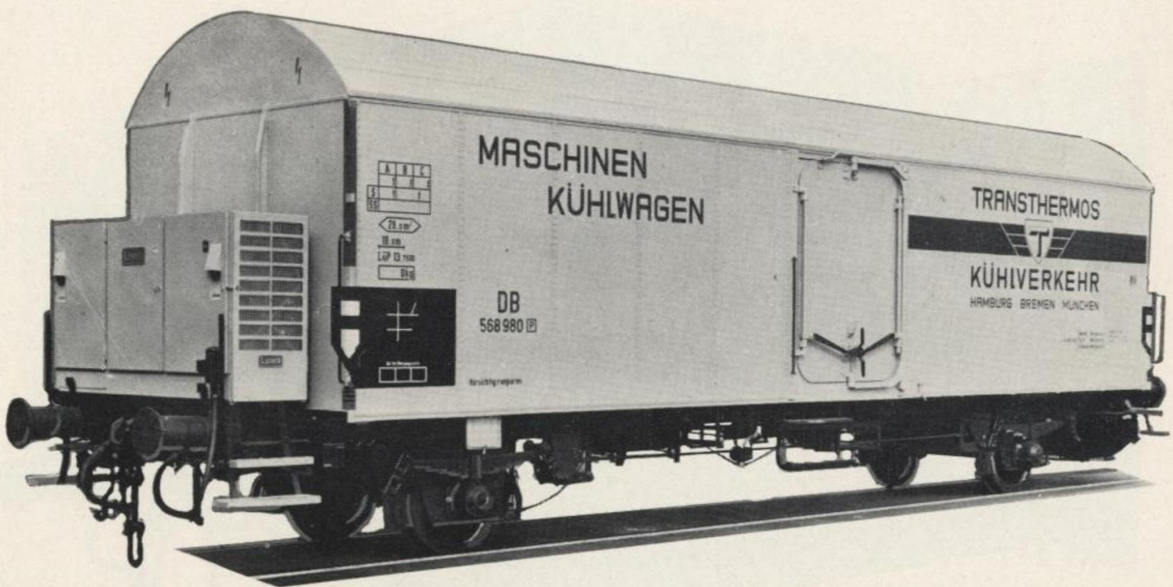
**Kälte bzw. Wärmeleistung steuerbar für einen Temperaturbereich von  $+16^{\circ}\text{C}$  bis  $-30^{\circ}\text{C}$**
